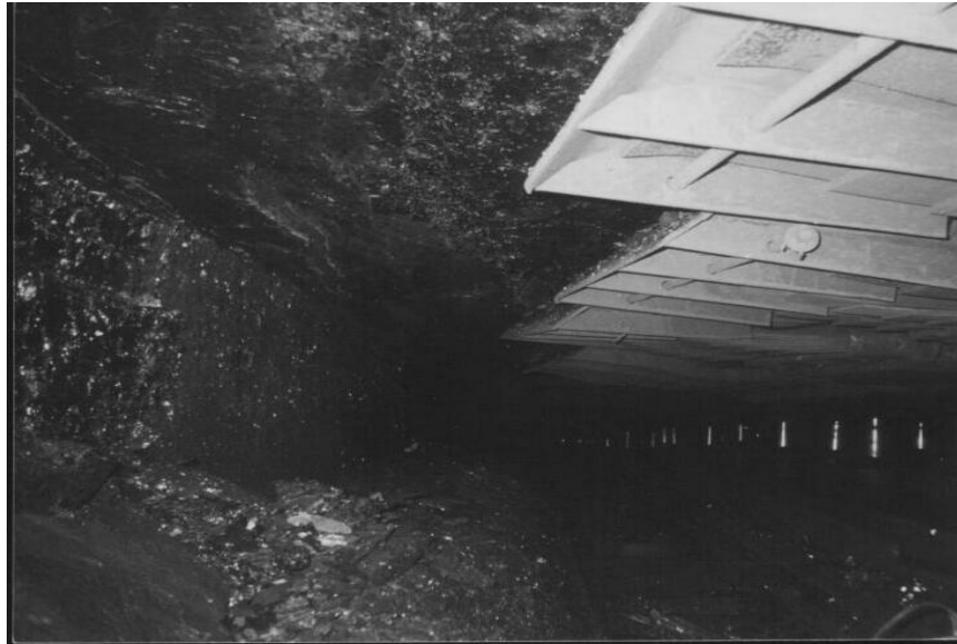
Рис. 4.10. Характер стану порід покрівлі в 7-й південній дослідно-промисловій лаві
