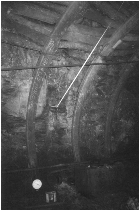
Рис. 4.4. Замірна реперна станція на №5 в 8-му південному бортовому хіднику а – загальний вигляд; б і в – відповідно вид зліва і вид справа
