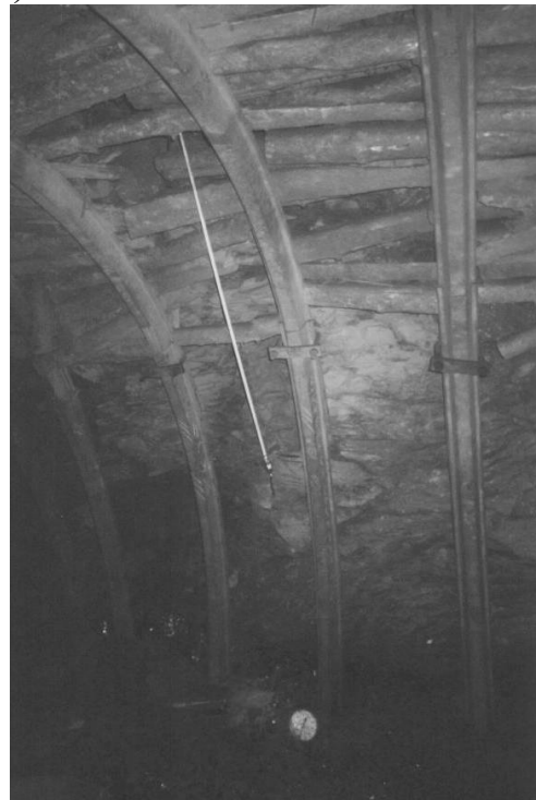
Рис. 4.4. Замірна реперна станція на №5 в 8-му південному бортовому хіднику а – загальний вигляд; б і в – відповідно вид зліва і вид справа
