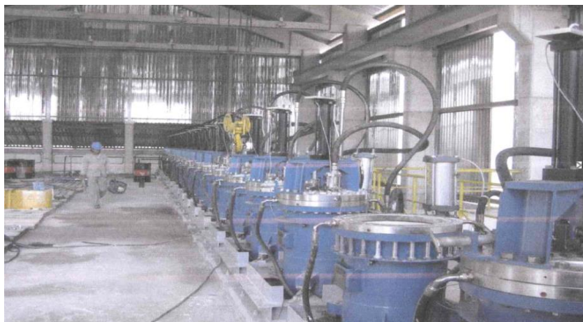
Рис. 7. Сгущение каолиновой суспензии в трубчатых пресс – фильтрах
