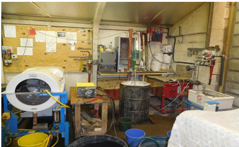
Рис. 1. Пилотная установка для обогащения ультратонких хромитовых шламов
