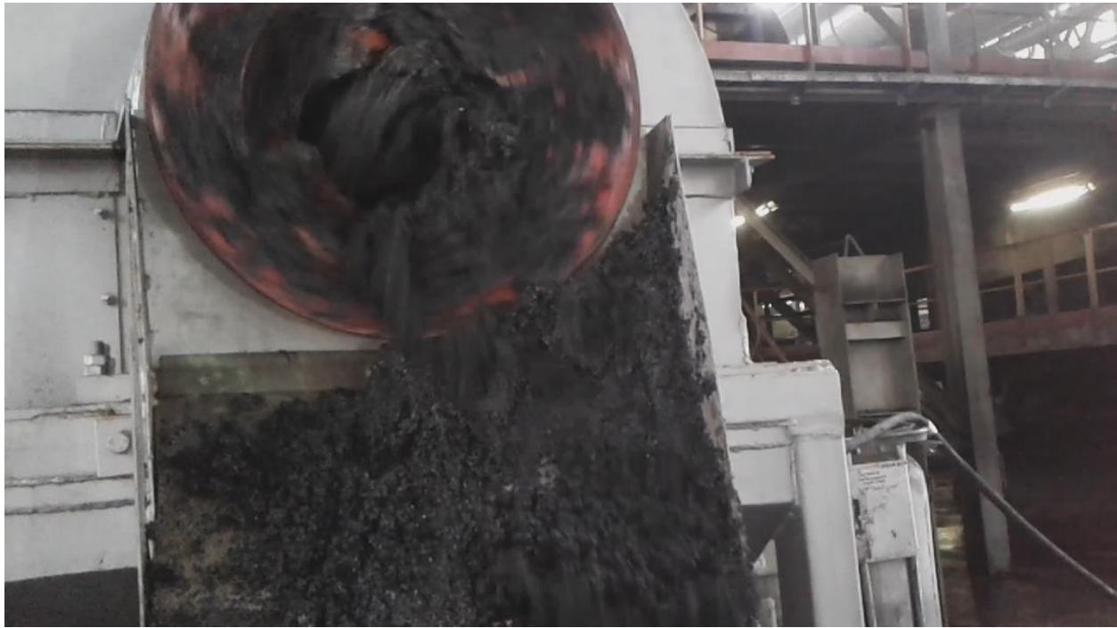
Рис. 3. Выгрузка надрешетного продукта барабанного сита
