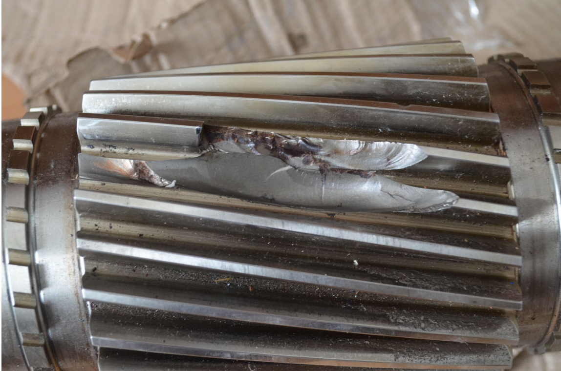
Рис.1. – Уламок зуба вала-шестерні редуктора турбогенератора типу SST-110
