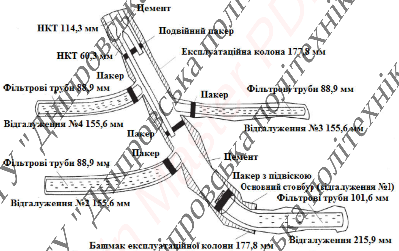
Рис. 6.2. Схема закінчення РГС і об'язки внутрішньо-свердловинного обладнання
