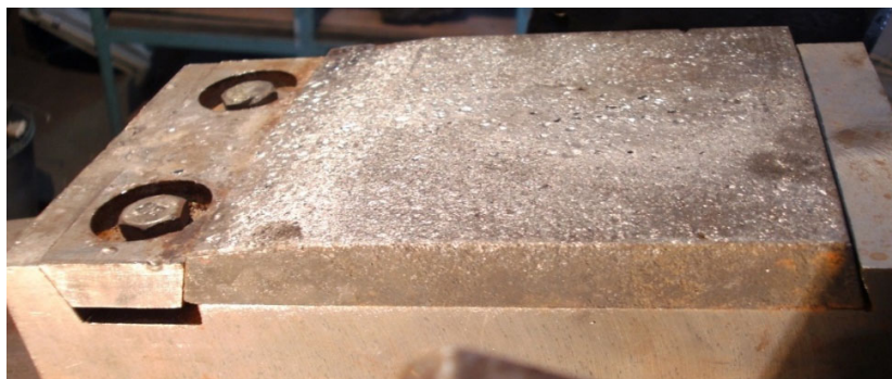
Рисунок 1 - футерувальна плита з плоскою робочою поверхнею а - установка плити в дробарці; б - робоча поверхня плити
