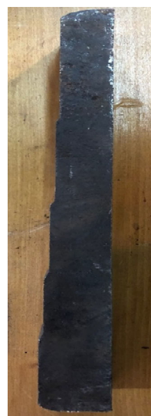
Рисунок 2 - Ступінчаста форма робочої поверхні щіки: а - конструктивна схема розташування плит в дробарці б - форма торця плити
