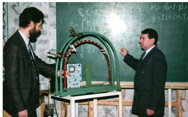
Вивчення деформацій металевого кріплення. Проф. А. М. Роєнко, доц. О.В. Солодянкін
