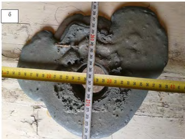
Рис. 13. Радіус поширення ТПКМ у тріщині з розкриттям 20 мм: а – тампонажний камінь у моделі горизонту; б – вигляд зверху
