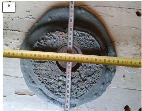
Рис. 14. Радіус поширення ТПКМ у тріщині з розкриттям 30 мм: а – тампонажний камінь у моделі горизонту; б – вигляд зверху
