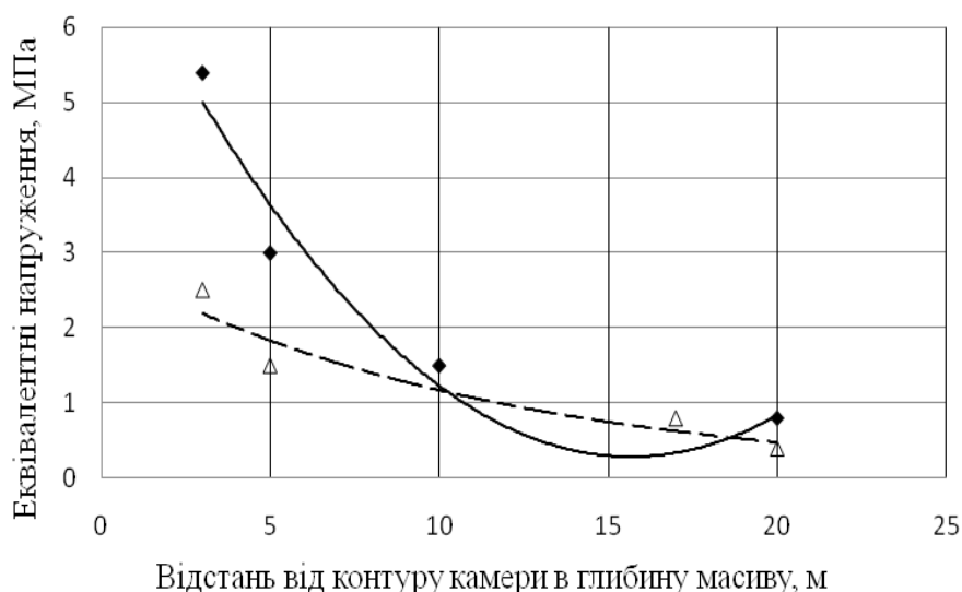
Рис. 2. Залежності зміни еквівалентних напружень на випуклостях камери: — у бік виробленого простору; - - у бік закладного масиву
