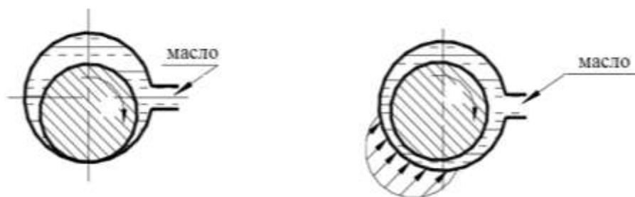
Рисунок 3.6. Схема роботи гідростатичного плаваючого вкладиша підшипника ковзання
