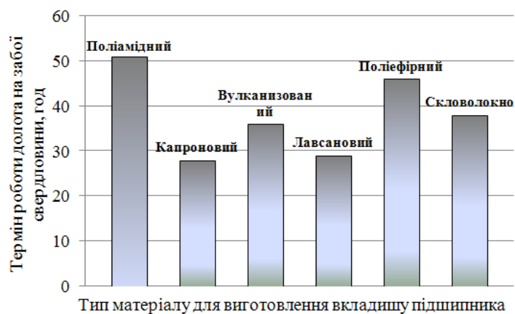
Рисунок 3.8. Залежність терміну роботи долота на забої від типу матеріалу для виготовлення вкладишу підшипника
