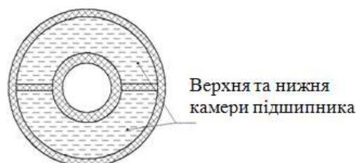
Рисунок 3.5. Схема роботи плаваючого вкладиша підшипника ковзання
