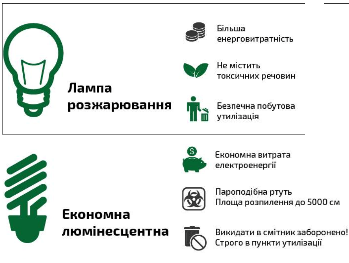
Рисунок 3.7 – Переваги та недоліки ламп розжарювання та люмінесцентних ламп
