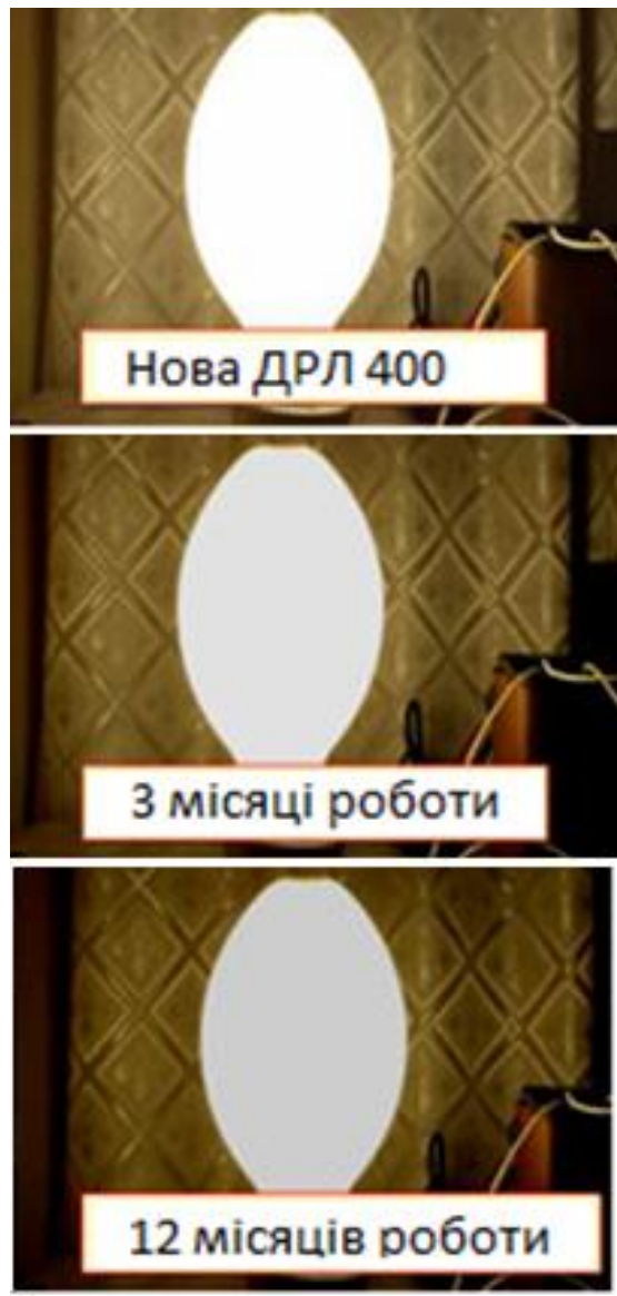
Рисунок 3.9– Зниження яскравості ДРЛ лампи протягом терміну експлуатації
