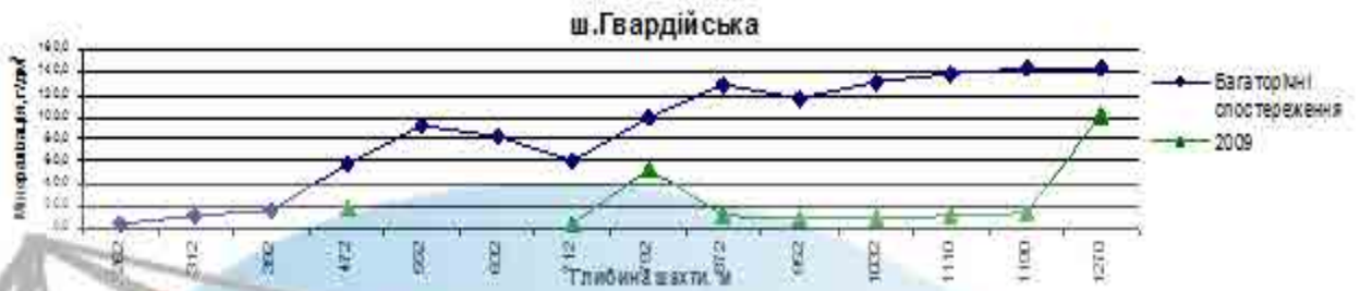
Рисунок 2.15 Графік співставлення мінералізації підземних вод на початку експлуатації и станом на 2009 рік
