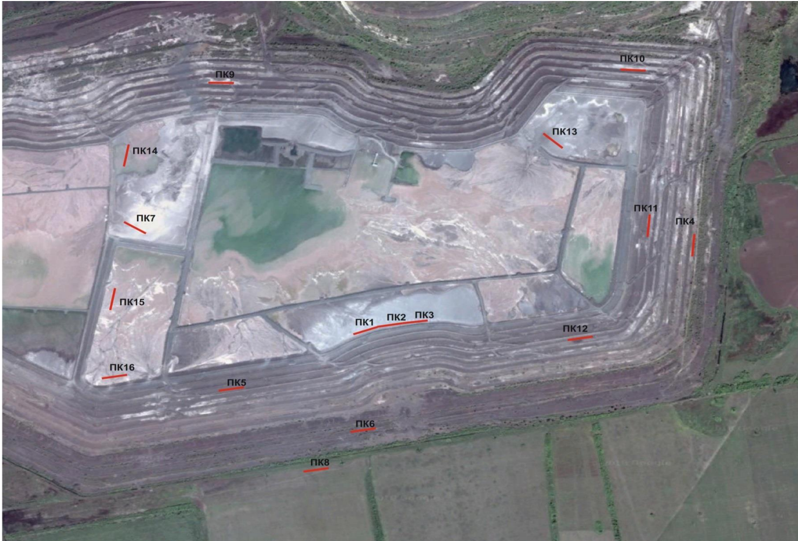
Рис.5.4. Схема розташування розстановок сейсмозв'ідки МЗХ
