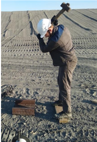
Рис. 5.9. Збудження поздовжніх Р-хвиль (а) і поперечних SH-хвиль (б)
