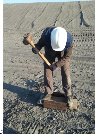
Рис. 5.9. Збудження поздовжніх Р-хвиль (а) і поперечних SH-хвиль (б)
