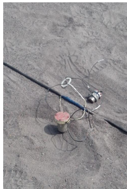
Рис. 5.6. Сеймоприймачі для реєстрації поздовжніх та поперечних хвиль
