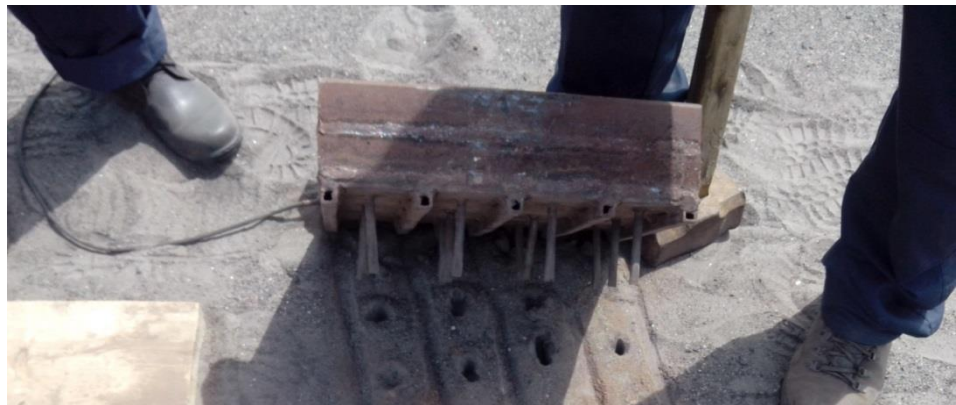
Рис. 5.8. Металева підкладка для збудження сейсмічних коливань типу «борона»
