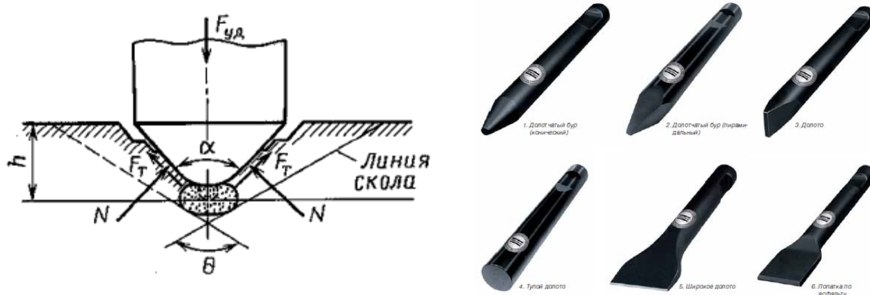
Рисунок 3.6 – Схема сил, що діють при ударному бурінні та типи долот
