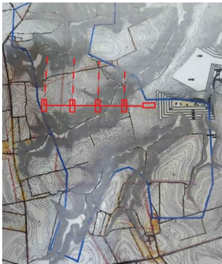
Рис. 3. Технологічна схема розробки передового уступу роторним комплексом поперечними заходками
