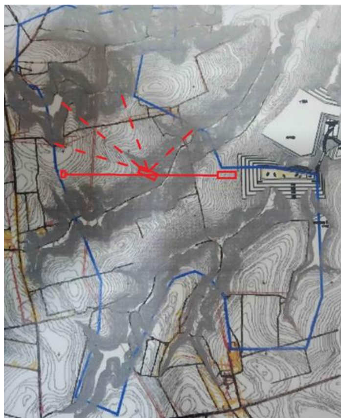
Рис.4. Технологічна схема розробки передового уступу роторним комплексом діагональними заходками при віяловому переміщенні фронту розкривних робіт
