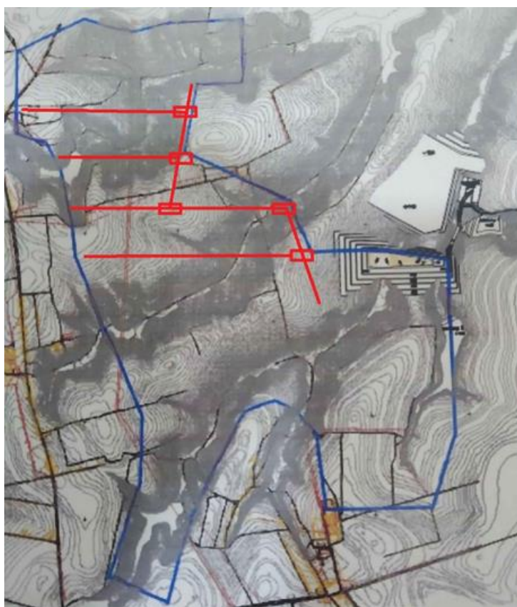
Рис. 2. Технологічна схема розробки передового уступу роторним комплексом поздовжніми заходками
