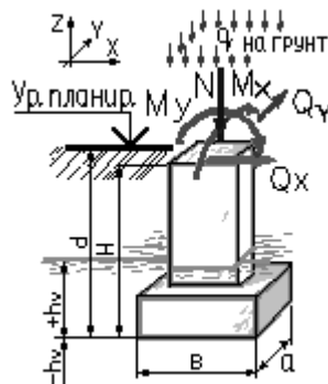
Рисунок 2.6 – Схема стовпчастого фундаменту на природній основі
