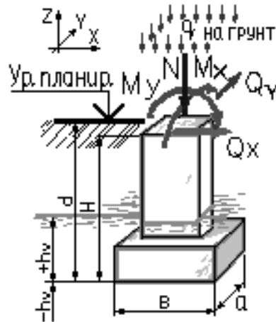
Рисунок 2.2 – Схема тип фундаменту: стовпчастий на природній основі
