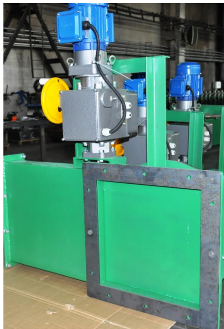
Рисунок 2.5 – Шибер ЗПВЕ-200 з електроприводом
