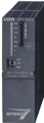
Рисунок 2.9 – Програмований логічний контролер VIPA 300V 314-2BG03
