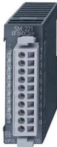
Рисунок 2.8 – Модуль дискретного виводу VIPA 222-1BF00
