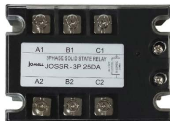
Рисунок 2.4 – Трифазне твердотільне реле Jotta SSR 40 (3x~380 В, 0-24 В)
