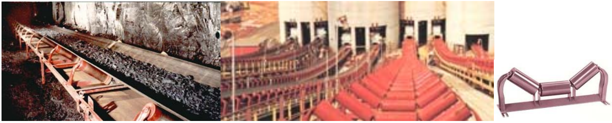
Рисунок 1.1 – Зовнішній вигляд стрічкового конвеєра і підтримувальних роликів
