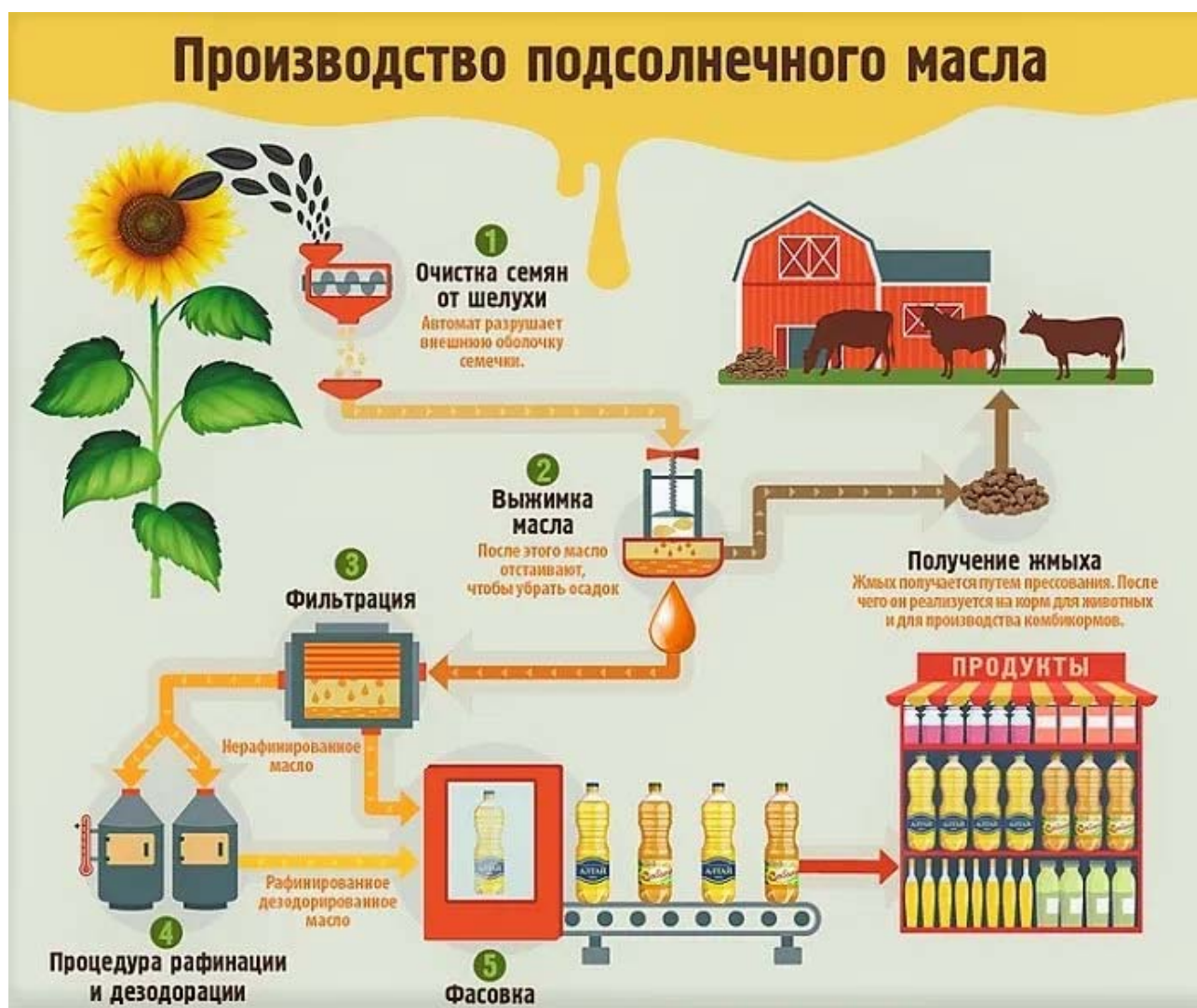
Рисунок 1.2 - Коротка схема технології виробництва рослинного масла
