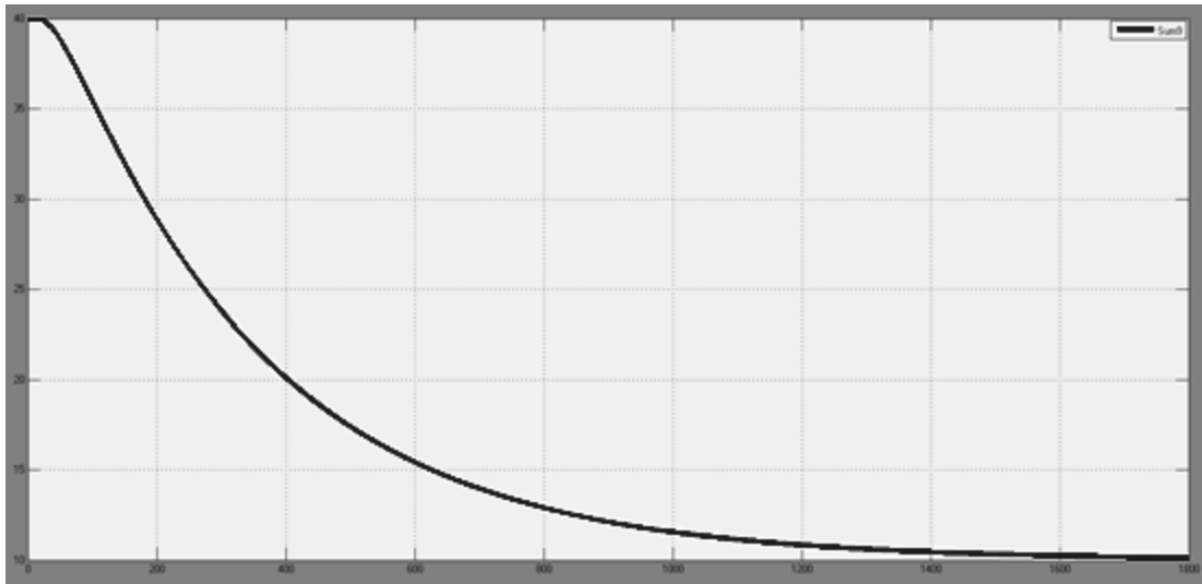
Рисунок 2.2 – Динамічна характеристика об’єкту керування
