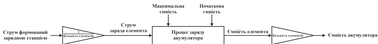
Рисунок 2.8 – Структура процесу заряду акумулятора електромобіля
