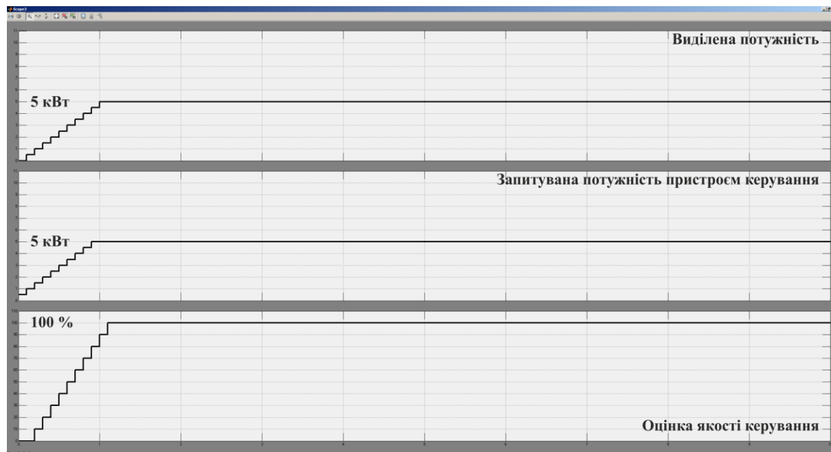
Рисунок 3.5 – Виділення потужності при запиті меншому максимальної потужності
