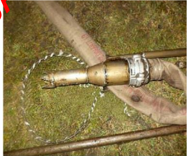
Рисунок 3.11 – Засоби видобутку бурштину способом підземного гідророзмивання [29]
