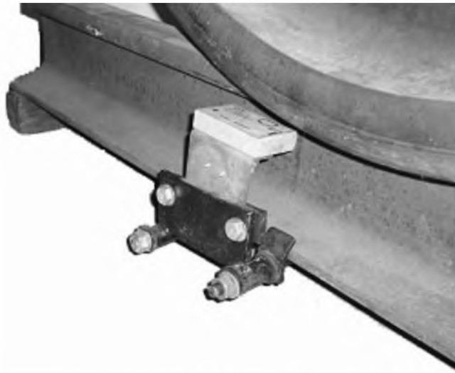
Рисунок 2.12 - датчик електронної фіксації проходу колісних ПАР ДС-96
