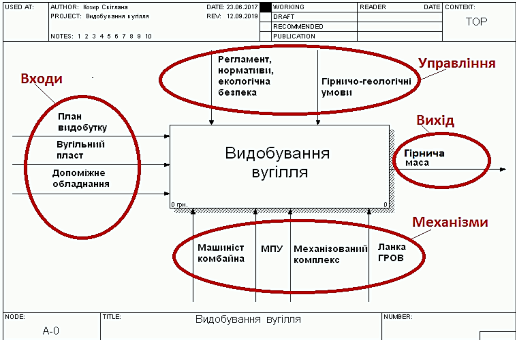
Рис. 4.9. Контекстна діаграма процесу «Видобування вугілля»
