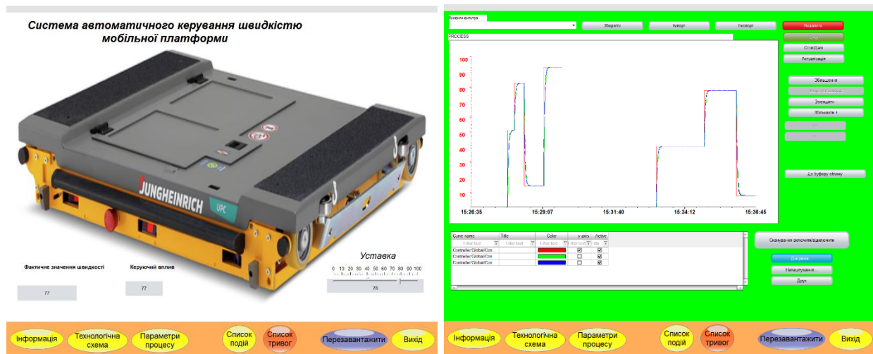
Рисунок 4.18 – Перевірка функціонування ПЗ системи автоматичного керування
