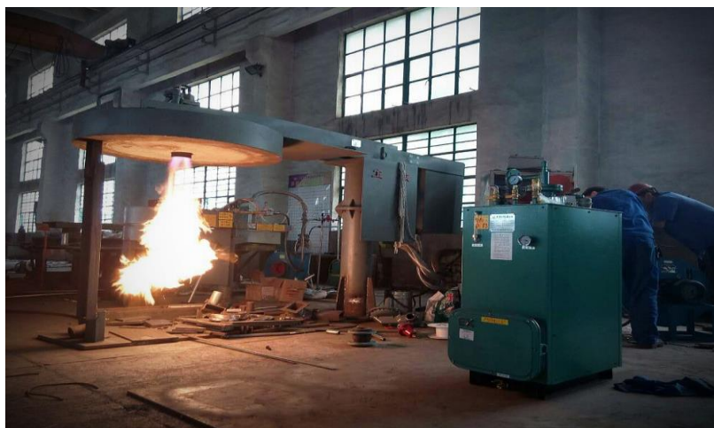
Рисунок 1.4 – Зовнішній вигляд установки для сушки та нагріву ковшів
