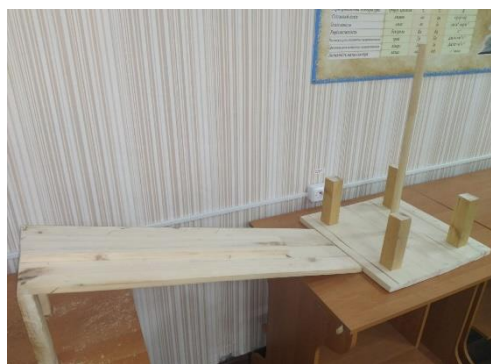
Рис. 3 Реальна модель: а – пандус з тестером; б – розроблена конструкція
