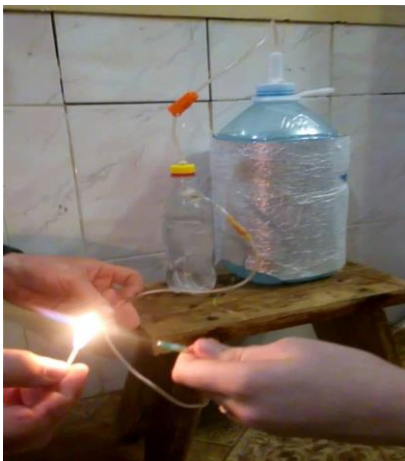
Рис. 3 Фотографія біогазової установки з циклічним принципом дії
