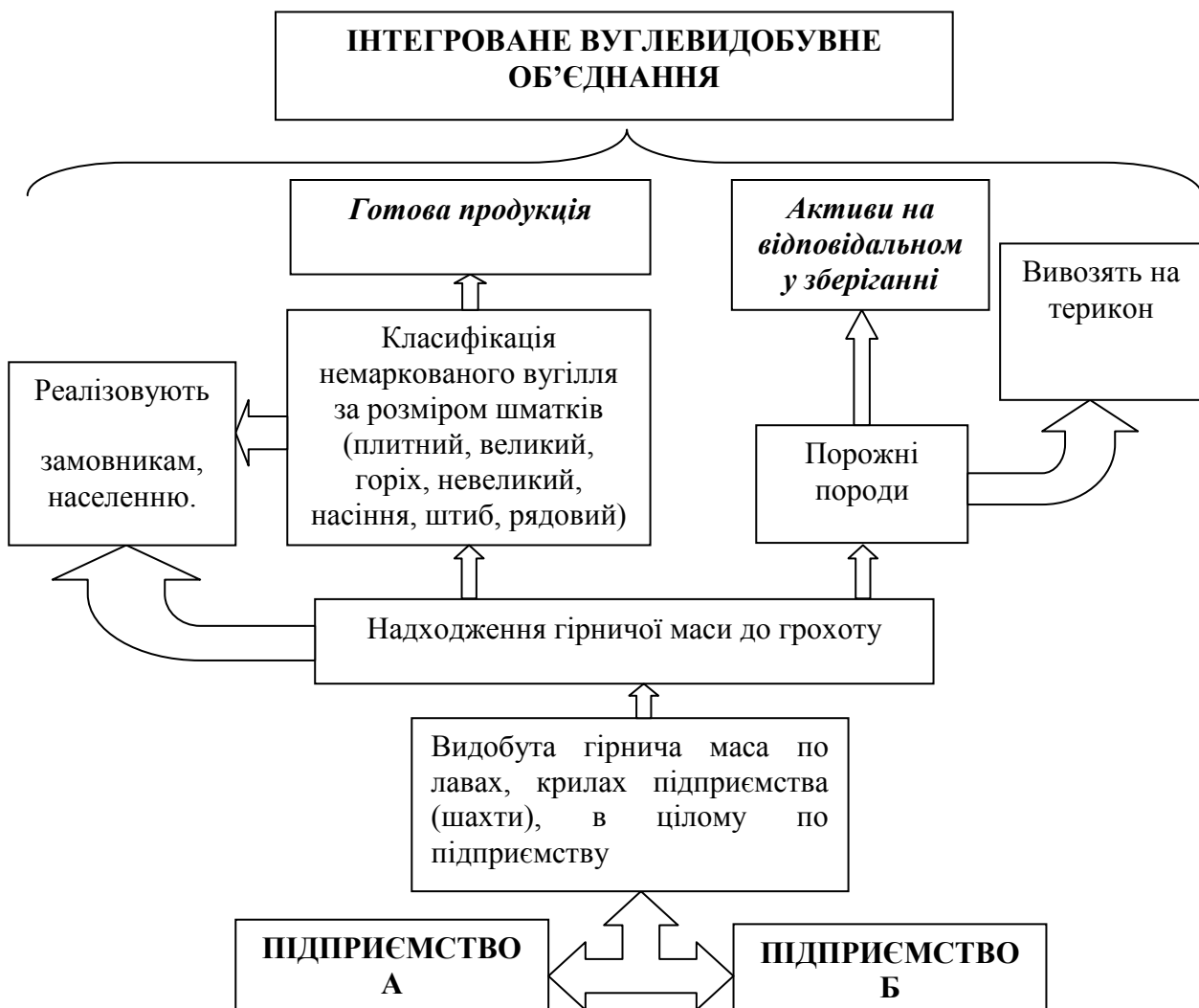
Рисунок 5.1 – Структура функціонування інтегрованого вугледобувного об'єднання без збагачувальної фабрики
