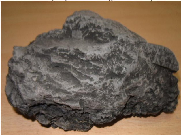
Рисунок 3.7 – Сингенетична силікатна фракція у вугіллі
