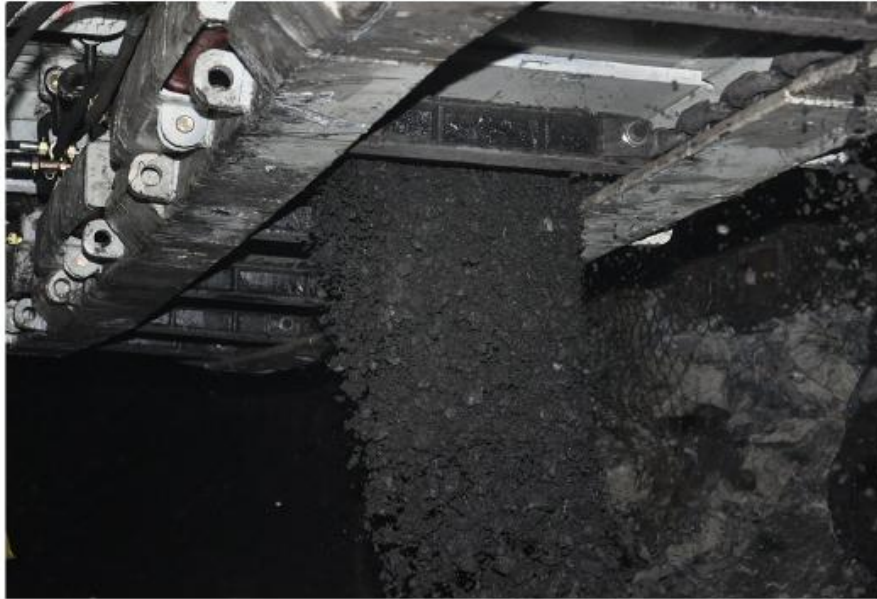
Рисунок 2.11 – Процес донного розвантаження породи у вироблений простір
