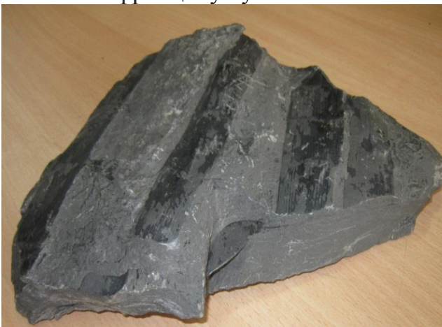
Рисунок 3.9 - Сингенетична силікатна фракція у вугіллі
