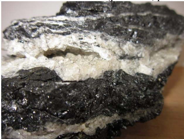
Рисунок 3.11 – Епігенетична карбонатна мінералізація у вугіллі
