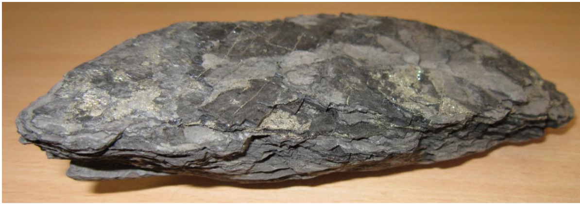
Рисунок 3.6 – Епігенетична сульфідна мінералізація у вугіллі
