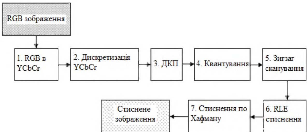
Рисунок 2.1 – Основні етапи процедури стиснення за стандартом JPEG
