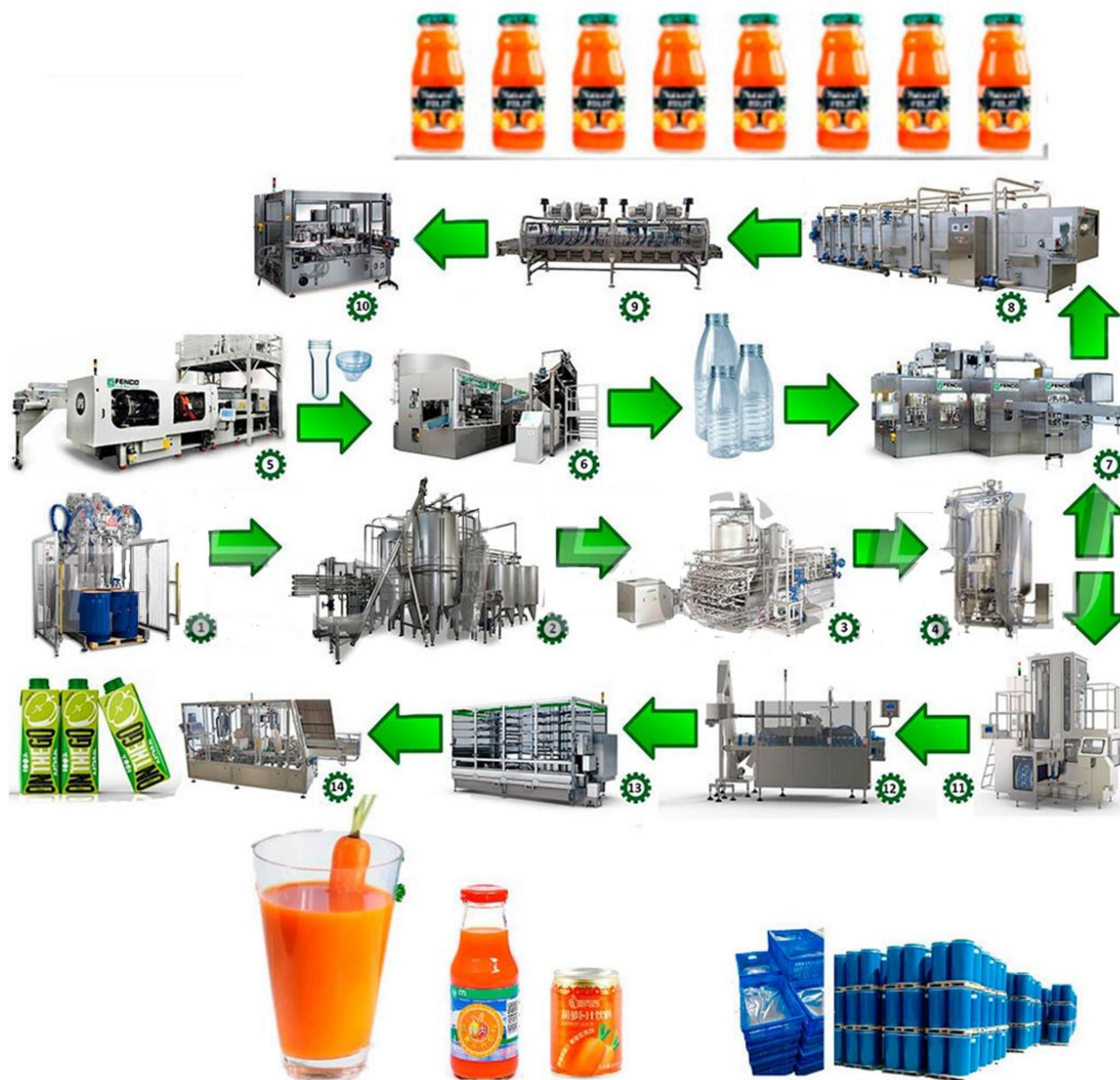
Рисунок 1.2 – Технологічна послідовність виробництва і розливу відновлених соків і нектарів
