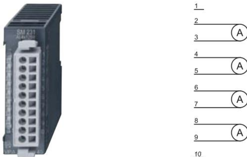
Рисунок 2.13 – Зовнішній вигляд та схема підключення модуля 231-1BD40
