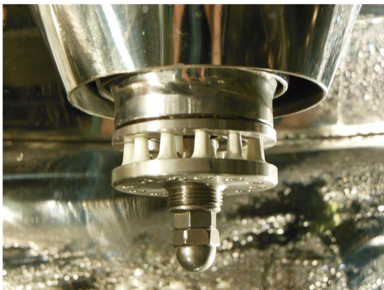
Рисунок 1.6 - розпилюючий диск у сушарці WUXI ATZ Atomizer 12-986/4-1
