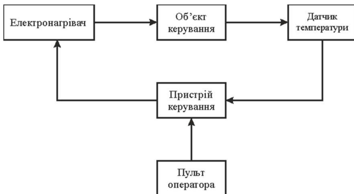
Рисунок 2.1 – Структурна схема системи керування температурою
