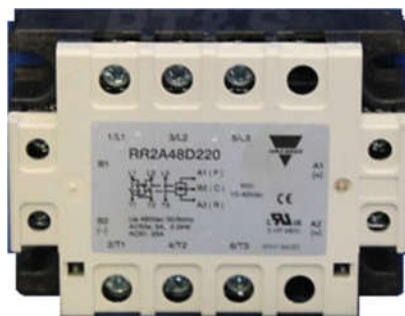
Рисунок 2.5 – Контролер реверсування асинхронного двигуна RR2A48D220
