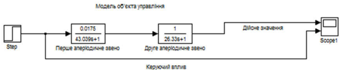
Рисунок 3.16 – Модель Simulink об'єкта керування
