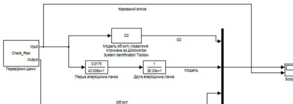
Рисунок 3.14– Модель Simulink об'єкта керування
