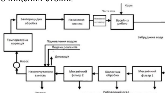
Рисунок 1 - Принципова схема Рециркуляційної аквакультурної системи
