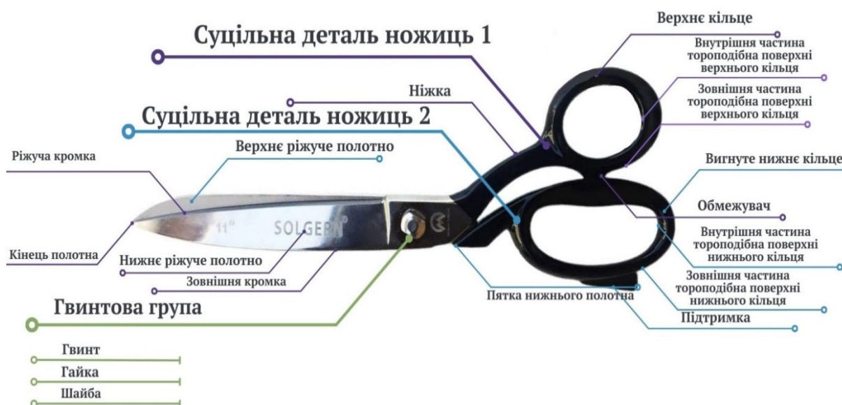
Рис. 3. – Схема деталей та елементів кравецьких ножиць «SOLGERN №8»
