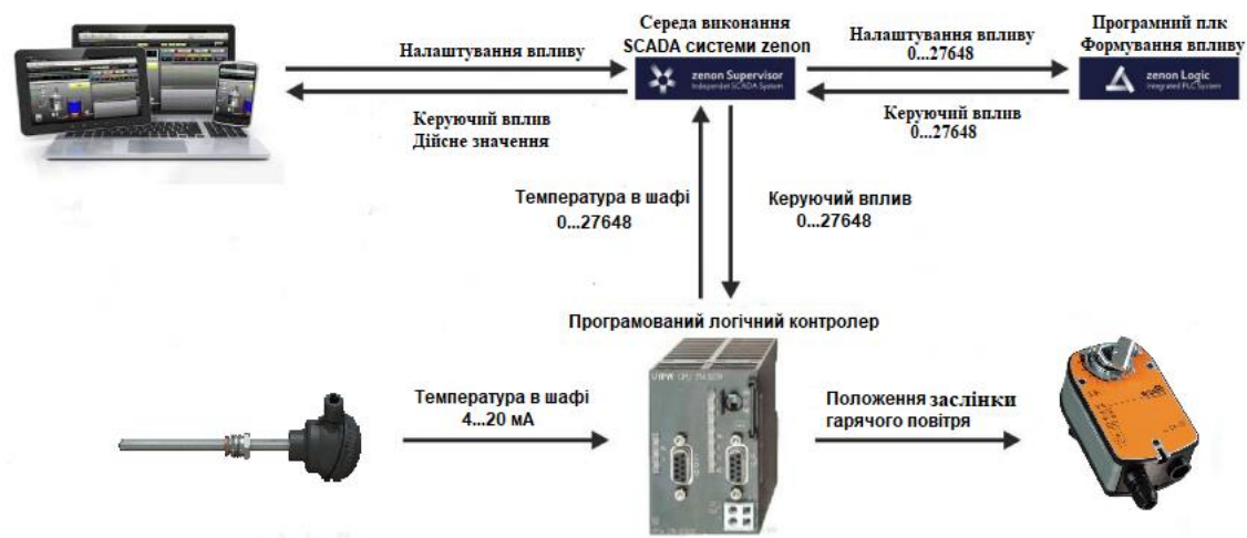
Рисунок 3.1 – Структурна схема інформаційних потоків дослідницької системи Зв'язок між ПЛК та ПК із SCADA системою zenon реалізується також завдяки інтерфейсу RS-485.
