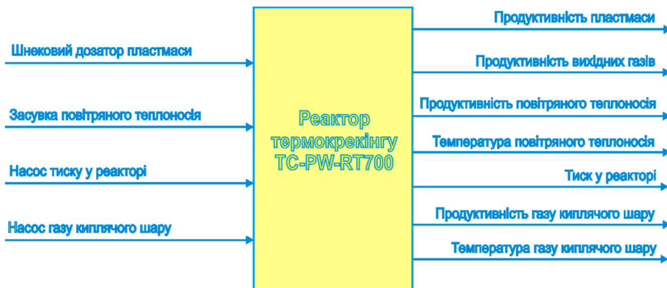
Рисунок 1.17 – Структура об'єкту керування – реактор термокрекінгу TC-PW-RT7000
