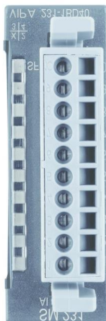
Рисунок 2.9- модуль аналогового вводу VIPA 231-1BD40
