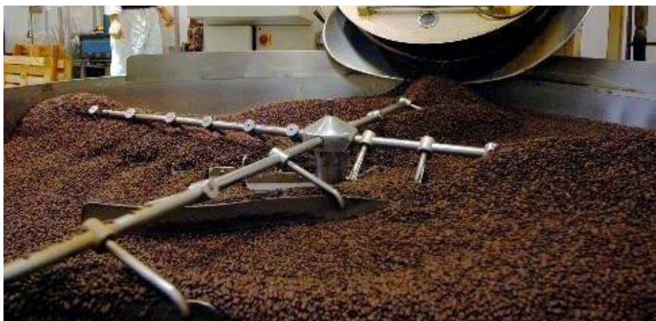
Рисунок 1.3 – Машинно для видалення газів з свіжо обсмаженої кави
