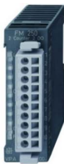
Рисунок 2.12 – Функціональний модуль 250-1BS00
