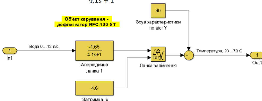
Рисунок 3.16 – Модель об'єкту керування (дефлегматор RFC-100 ST)
