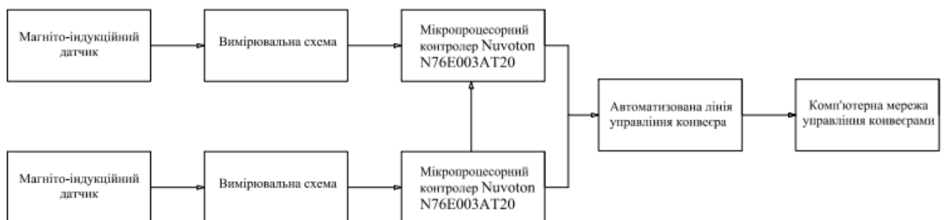
Рис. 2.11 – Структурна схема контролю стану стикового з'єднання конвеєрної стрічки для однієї точки контролю
