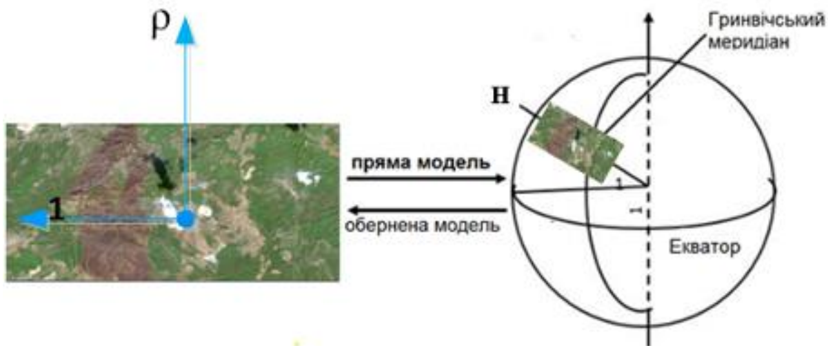
Рис. 1. Геометрична проекція: \rho – значення зображення у пікселях; H – висота, з якої отримано зображення
