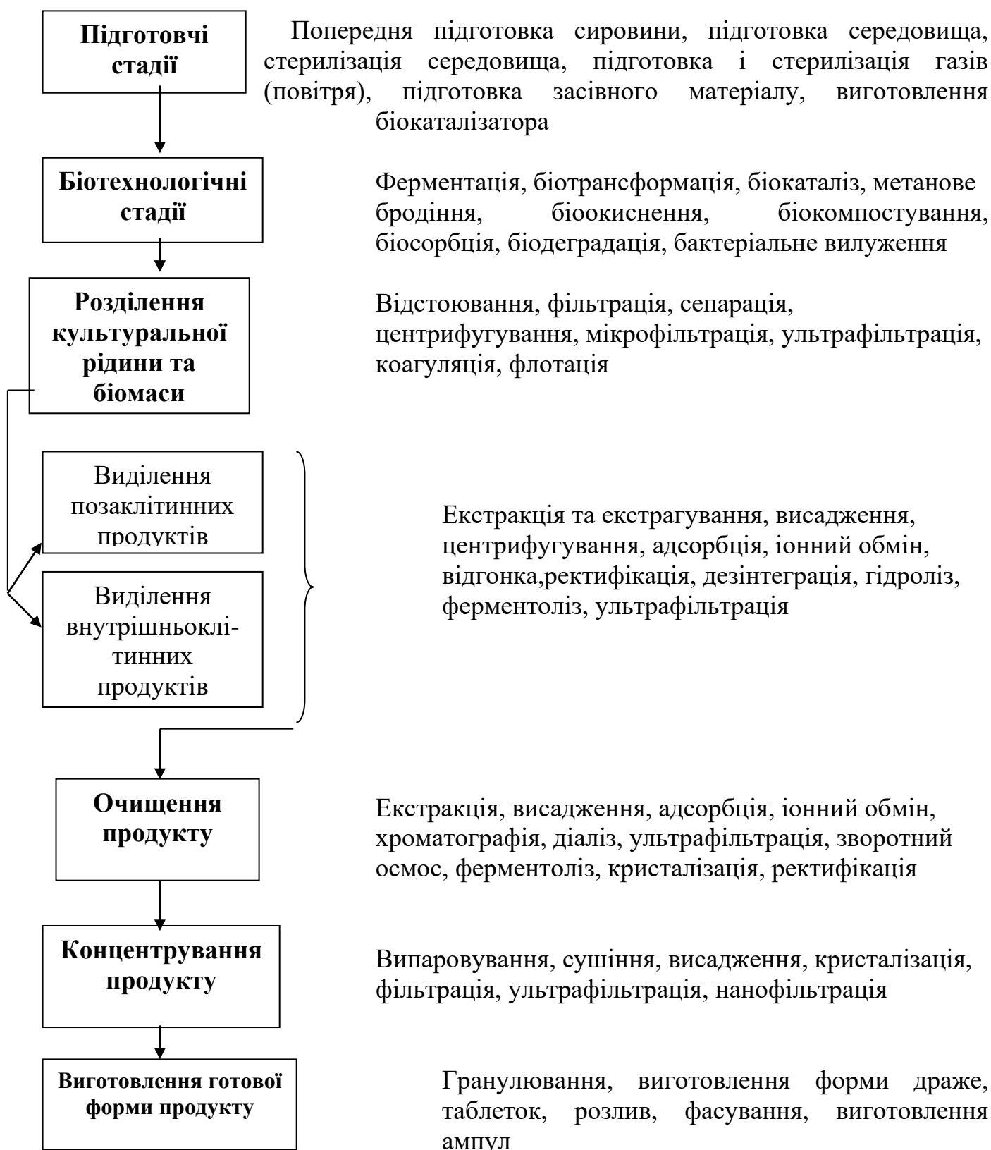
Рис. 2.3. Узагальнена схема основних стадій біотехнологічного виробництва
