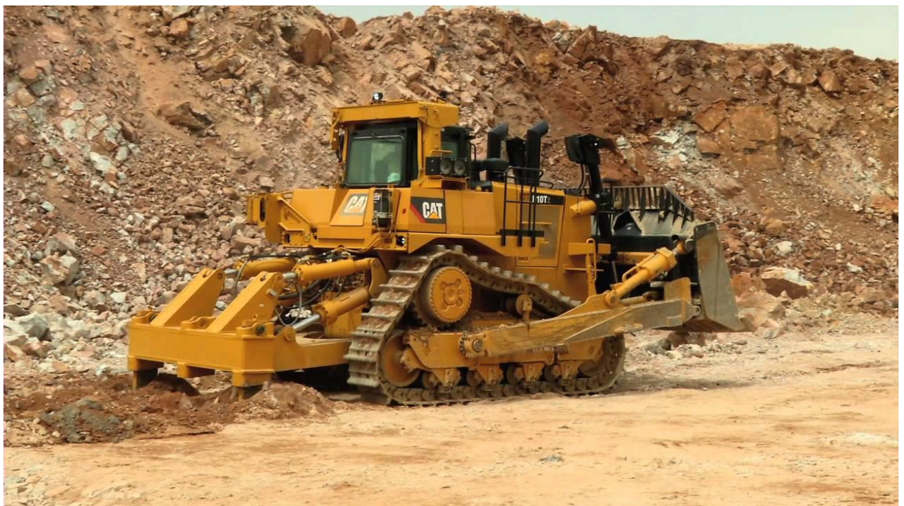
Рис. 2.1. Загальний вигляд бульдозера Cat D10T на відвалі
