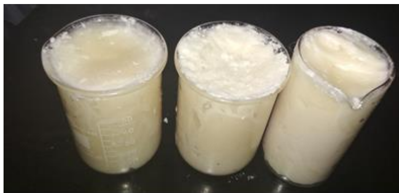
Рис. 3.4 Вигляд зразків емульсії після термічного циклування (8 циклів)
