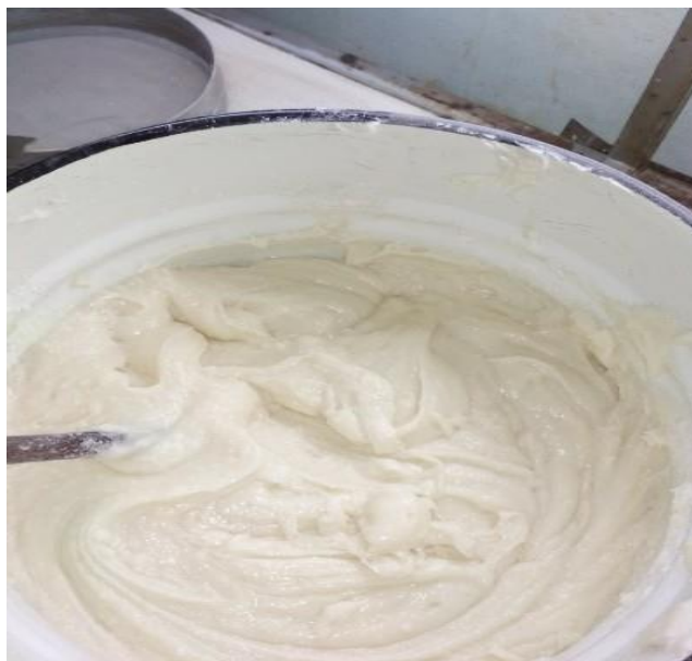
Рисунок 5. Масса ПЭВВ после смешения компонентов.
