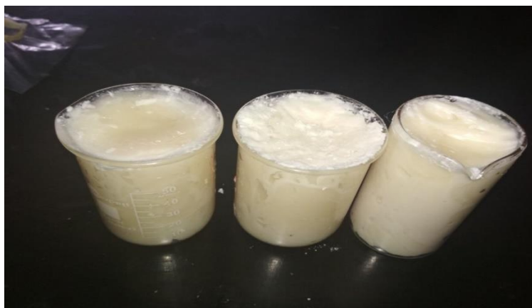
Рисунок 2. Эмульсия после термоциклирования.
