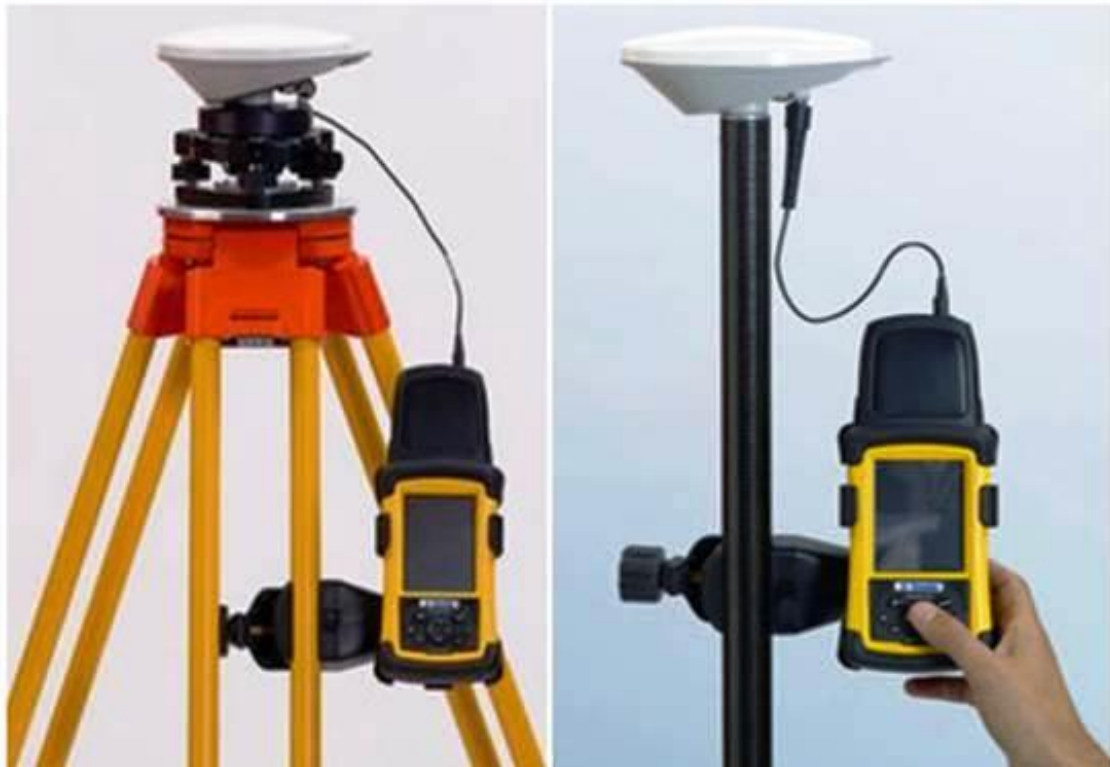
Рис. 1.11 – ГНСС-приймач з контролером підготовлені до виконання робіт
