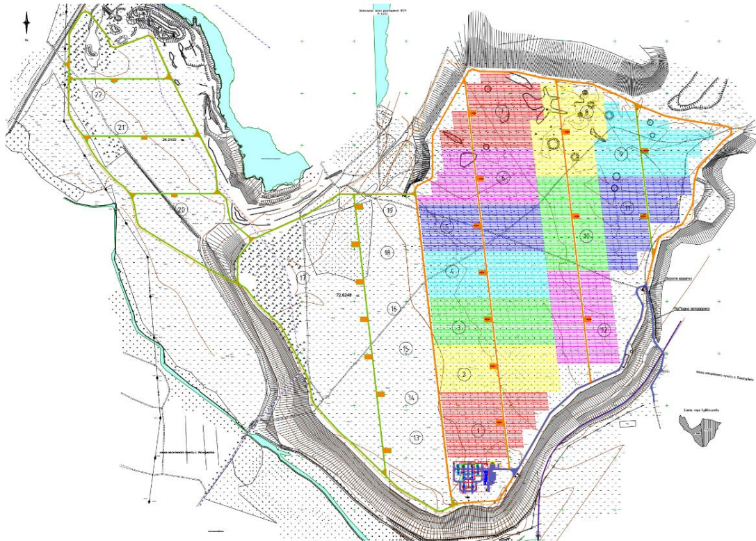
Рисунок 2.10 - Зони розташування фотогальванічних панелей за інверторними станціями
