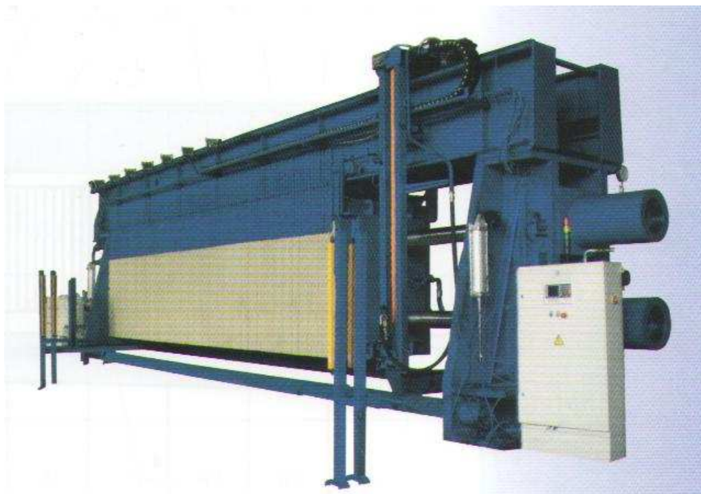
Рис. 7.29. Общий вид камерного фильтр-пресса типа ФКМ с верхней подвеской фильтровальных плит
